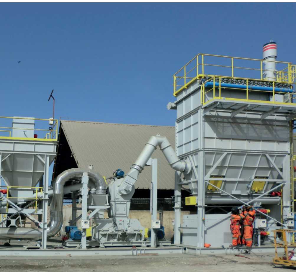
Mulino Rotodue 4C/500 per macinazione di coke di petrolio Mill Rotodue 4C/500 grinding unit of petroleum coke Broyeur Rotodue 4C/500 pour coke de pétrole
