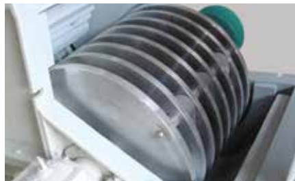
Particolare del rotore a dischi / Detail of standard disc rotor / Détail du rotor à disques
