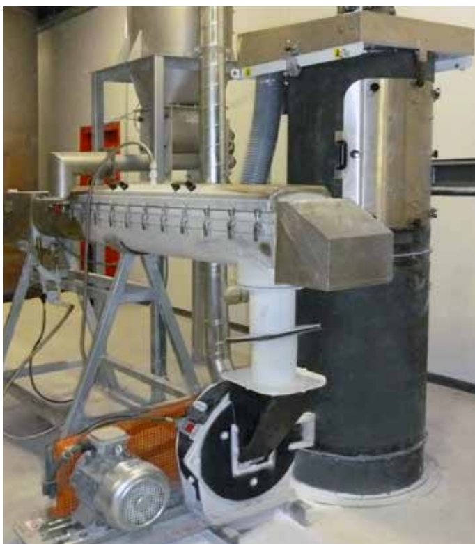
Impianto automatico con polverizzatore "x" e sistema criogenico per materiali termosensibili. Automatic plant with mill "x" and cryogenic system suitable for thermosensitive products.
