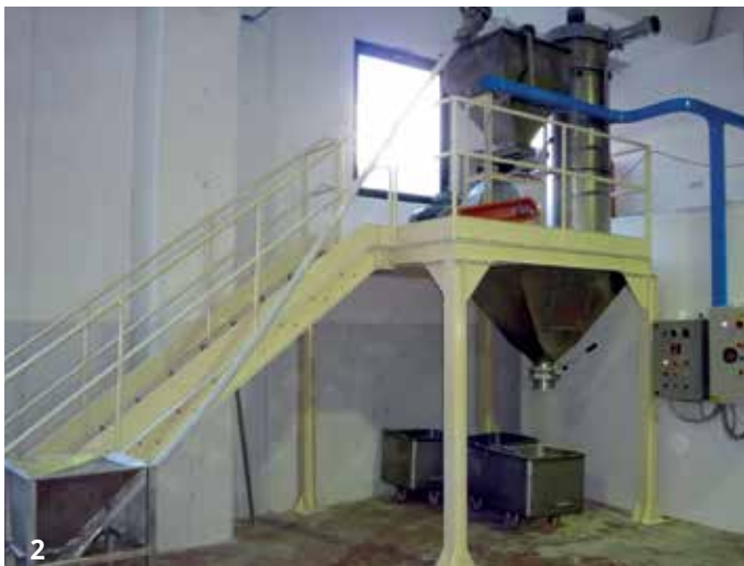
1 - Impianto di polverizzazione gomma arabica / Pulverizing plant for arabic gum
